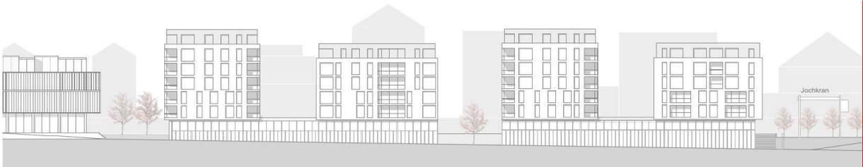
Abbildung 34: Richtprojekt mit differenzierter Höhenentwicklung und Attikageschossen (Quelle: KCAP Architects&Planners)
