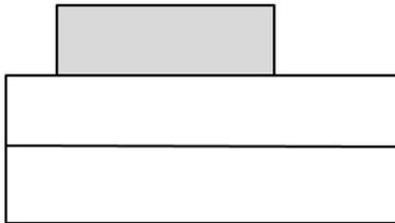
Ein Attika (-Geschoss) ist ein auf ein Flachdach gesetztes Dachgeschoss mit Flachdach, das – sofern es sich an die Vorgaben von Art. 25 BZO hält – nicht an die Ausnützung angerechnet wird.
