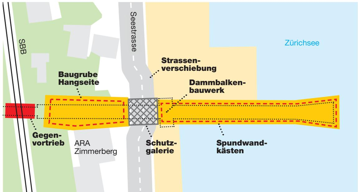
..... Künftiges Auslaufbauwerk des Entlastungsstollens (grösstenteils unterirdisch bzw. im Wasser)
