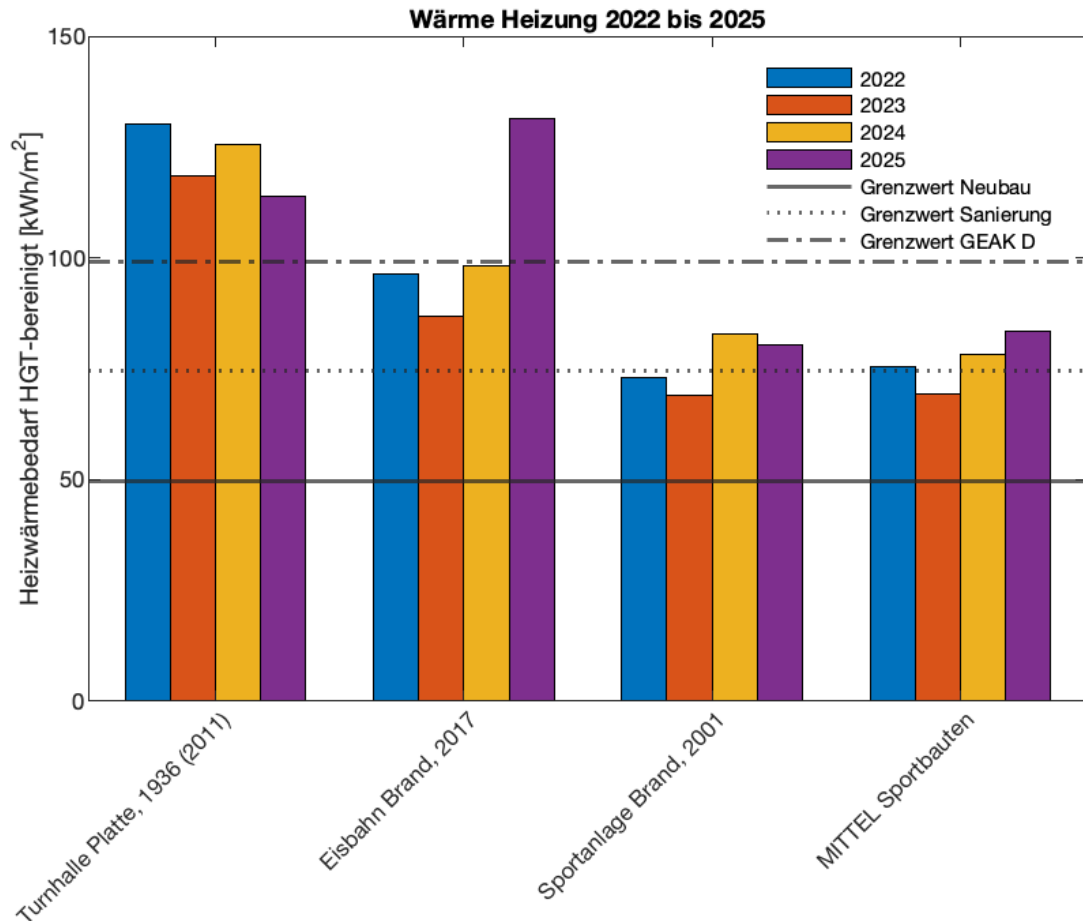
Abbildung 4 Heizwärmebedarf der Liegenschaften der Nutzung Sportbauten Name der Liegenschaft, Baujahr (Sanierungsjahr) Liegenschaften geordnet von kleinster Energiebezugsfläche (links) zu grösster (rechts)
