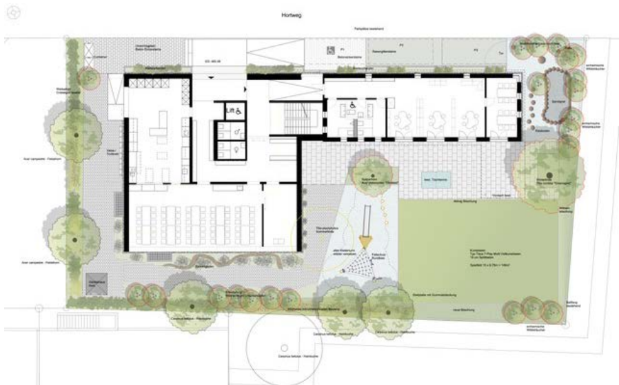
Abbildung 4 Grundriss Erdgeschoss des neuen Horts, inklusive Umgebungsgestaltung.
