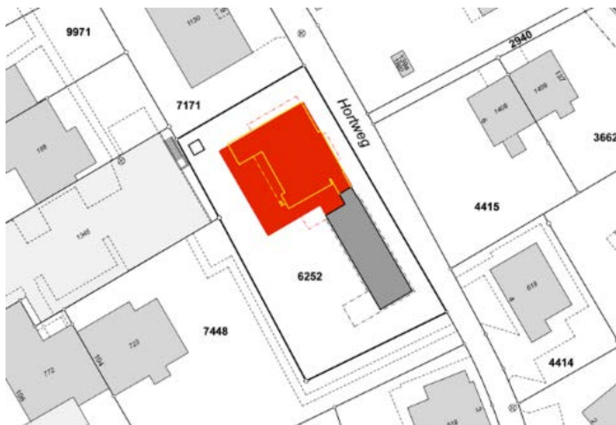
Abbildung 2 Situationsplan, der zeigt, wie der Teilneubau (rot) an den Erweiterungsbau angedockt wird. Gelb eingezeichnet ist der aktuelle Grundriss.
